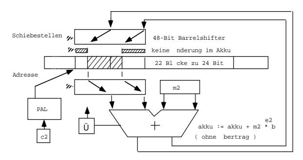
Dann haben auflaufende Rechnungen keine Rundungsfehler, schlecht konditionierte numerische Probleme bleiben handhabbar und eine exakte Fehlereingrenzung wird möglich.
