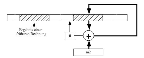
Wo die Addition angesetzt wird, bestimmt sich aus der Charakteristik und wird durch einen entsprechenden Zugriff auf dem Akkumulator geleistet, der als schneller Speicher M(i) zu 22 Worten à 24 Bit organisiert ist. Ausgelesen werden 48 Bit: M(i) ## M(i+1). Die Adresse bestimmt sich zu  $(2*e_0-1-c)$  div 6 und das 48-Bit-Wort durchläuft Barrelshifter, in denen es um  $4*[(2e_0-1-c) \bmod 6]$  Bit geschoben wird.
