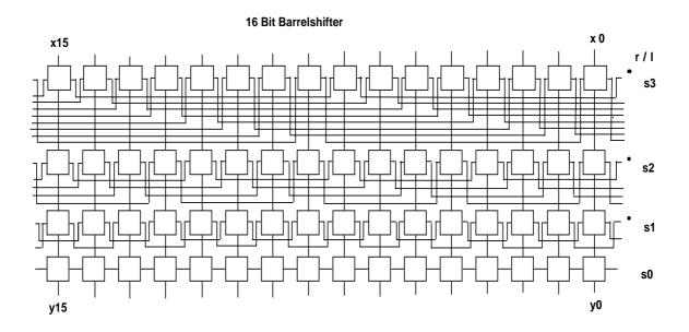
Die Schaltung zum Nachschieben von Null, Eins oder den zyklisch herausfallenden Werten ist nicht mit angegeben. Der Übersichtlichkeit halber ist hier ein 16-Bit-Barrelshifter gezeigt. Der Barrelshifter ist nach beiden Seiten hin verlängerbar. Das kann benutzt werden, um ein Wort als Ganzes um ±n Bit zu verschieben.
