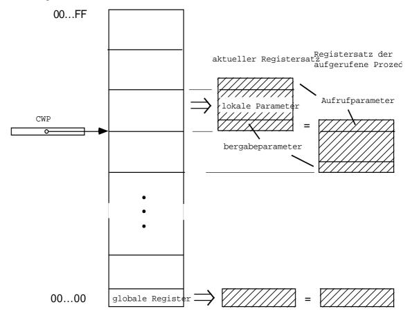
Der Prozeduraufruf benötigt dann keinen Transport von Parametern z. B. über einen Stack und ist dadurch schnell.
