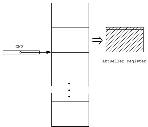
Eine Verfeinerung teilt den Registersatz auf in globale Register und ein Fenster. Bei einem Prozeduraufruf wird das Fenster überlappend weitergeschaltet.
