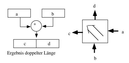
Ein 32 \* 32 - Bit Parallelmultiplizierer ist mit 1024 Zellen zu realisieren. Durch den regelmäßigen Aufbau problemlos integrierbar.
